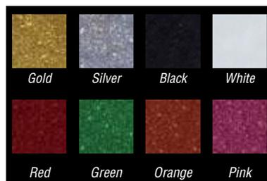
Se pueden suministrar metraje en múltiplos de 5 metros. Poliuretano textil termoadhesivo con colores perlados brillantes para aplicar sobre algodón, poliéster o polialgodón. Corte en espejo con cuchillas a 45°. Temperatura de aplicación 165 °C 17 segundos. Presión media/alta. Pelado en caliente.
